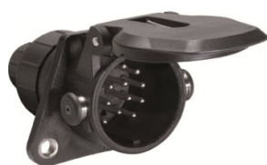
Art. 07.1035 Presa a 15 poli Normativa ADR/GGVS - ISO 12098 Termoplastico antiurto Attacchi a serrafilo
