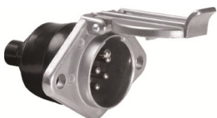
Art. 07.1027 Presa a 7 poli Versione "N" - ISO 1185 Alluminio pressofuso Attacchi a serrafilo
