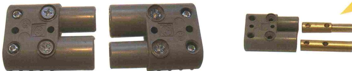
Realizzato in PBT di colore grigio monta contatti in OT-67 del diametro di 10 mm adatti ad una portata di 80A-B.T. con cavi di collegamento da 16 mmq.
