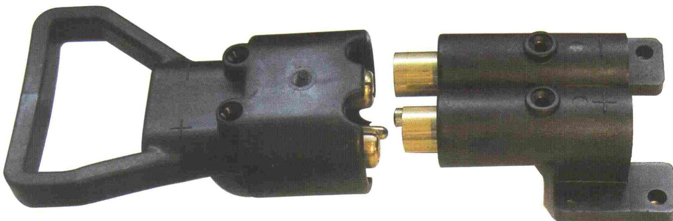
Connettore prodotto in poliammide 6.6-30 FV con contatti in OT-67 dimensionalmente adatti ad una portata di 175 A-B.T. e cavi di collegamento da 35 mmq.
